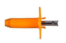
Bohrdübel mit Edelstahlhülse, oberflächenbündige Montage, Spezialdübel, einzusetzen mit speziellem Bohrhammer HILTI TE SX, dann Bohr- und Setzvorgang in einem Arbeitsschritt, Kombination mit HECK Dübelteller 90/140 "H",
