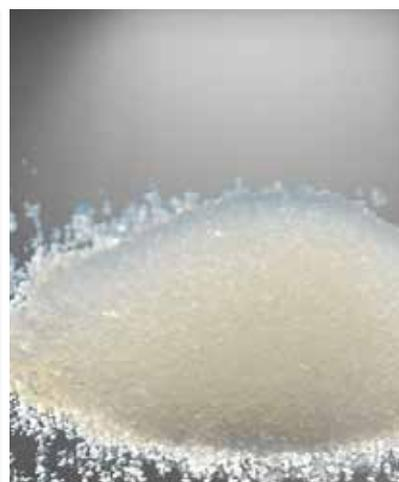
**Aus was besteht AEROGEL granulat?** AEROGEL granulat besteht aus 10% amorphes Silikat (Sand) und 90% Luft.
